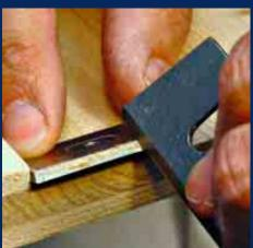
5. Achtung! Wendeplatten, Plattensitz und Spannkeil von Ablagerungen säubern, z.B. Harz- und Holzstaubablagerungen abschaben
